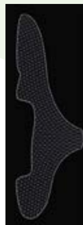
Einteilen der Grundform in Raster
