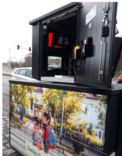
Das Bürgeramt erweitert mit einer semi-stationären Anlage seine Ausrüstung zur Geschwindigkeitsüberwachung im Straßenverkehr. Die Anlage namens „Toni“ – ein Blitzer-Anhänger, ausgestattet mit Sensoren und Kamera – ist jetzt an der südlichen Abfahrt der Europabrücke Richtung Schweiz erstmals aufgestellt worden.
