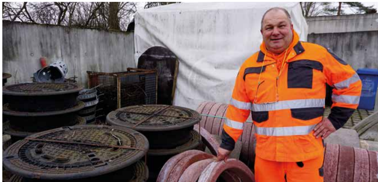
Auch massive Kanalabdeckungen halten nicht ewig. Auf dem Gelände der EBK hat Uwe Giermann immer Kanalabdeckungen aus Guss und Beton/Guss in verschiedenen Varianten sowie passende Ausgleichsringe vorrätig.
