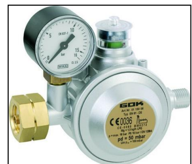
Sicherheits- Gewerberegler mit Überdrucksicherung und Flaschendruckanzeige
