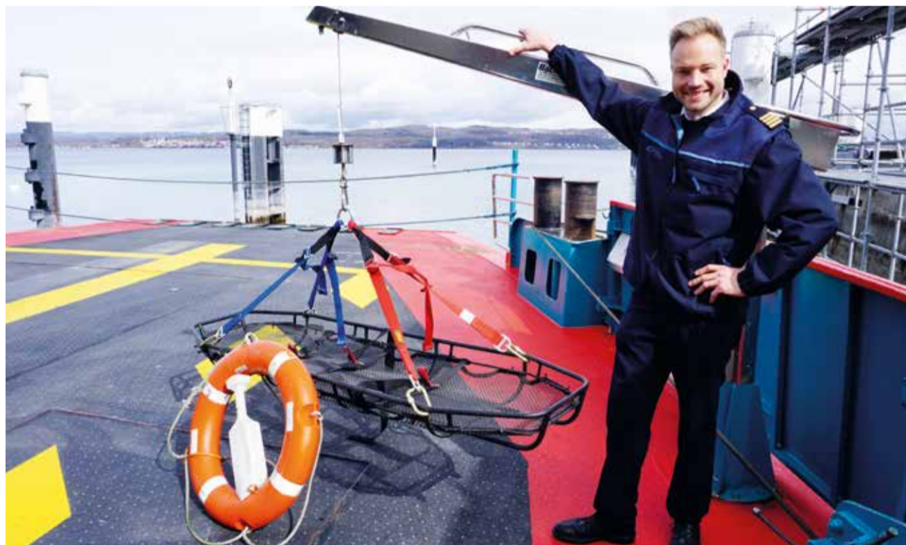
Am sogenannten Rettungs-Davit, dem Überbordkran, wird die Trage eingehängt, um Menschen aus dem Wasser zu bergen. Matthias Ihde probt mit seiner Mannschaft regelmäßig Rettungsmanöver, um bei Bedarf sofort eingreifen zu können.
